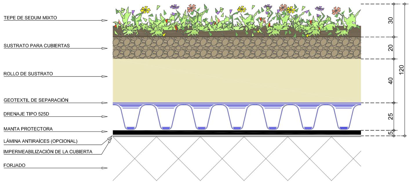
Impermeabilización de la cubierta: EPDM / bitumen / PVC
